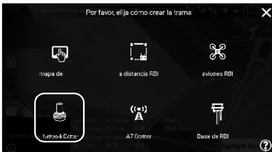
Paso 3: Busque el puntillador y conecte por Bluetooth al puntillador correspondiente.
